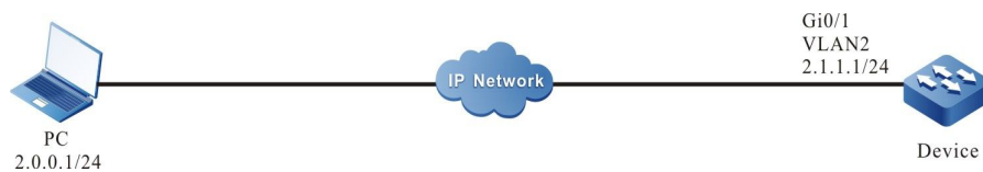
图 2-11 配置设备作为 SFTP 服务器组网图
