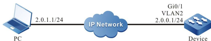
图 2-5 配置本地终端 Telnet 登录设备组网图
