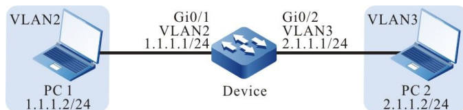
图 17-1 配置 VLAN 接口组网图
