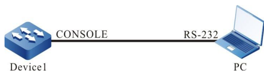
图 2-1 通过 Console 口登录设备的连接图
