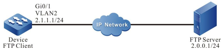
图 4-1 配置设备作为 FTP 客户端组网图
