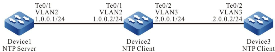
图 70-2 配置 NTP 服务器端与多级客户端组网图
