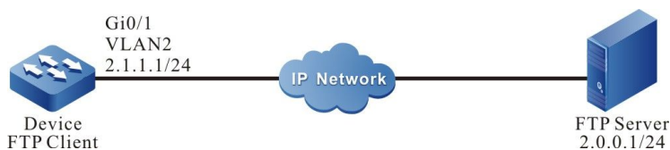
图 4-9 配置设备为 FTPS Client 组网图
