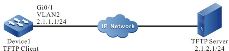
图 4-6 设备作为 TFTP 客户端组网图
