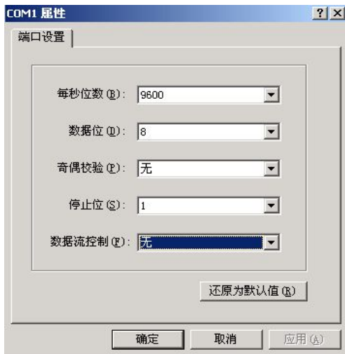
图 2-4 配置串行通信口参数
